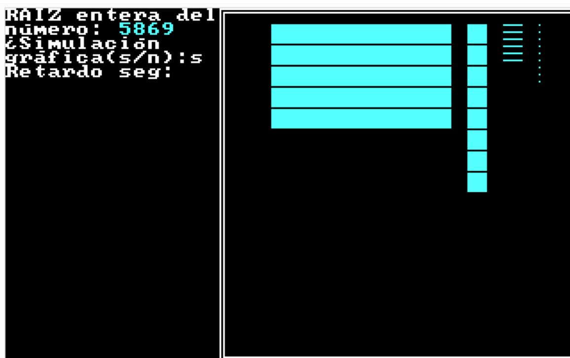
Figura 6: *Simulación de la raíz entera del número 5869.*
