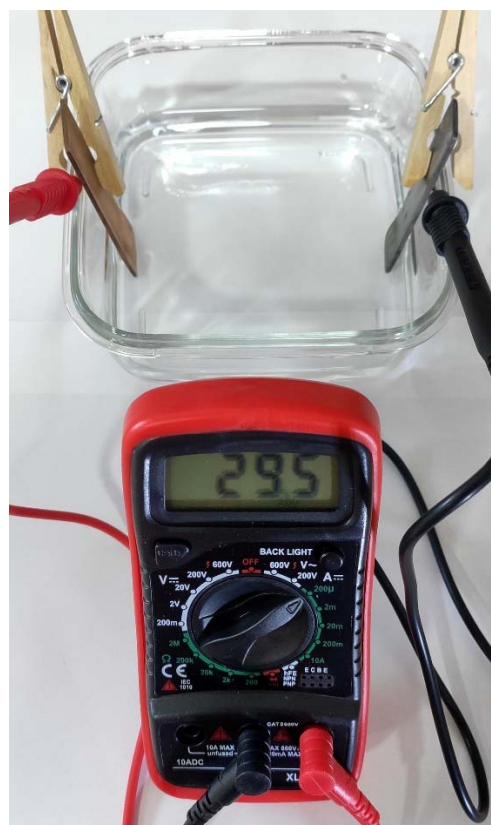
Figura 2. Montaje de la práctica.
