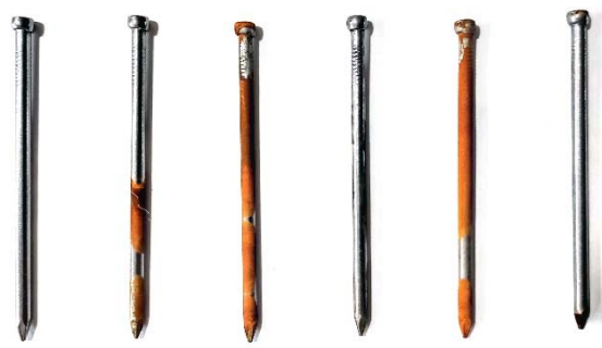
Figura 2. Aspecto de los clavos tras 3 días de exposición.
