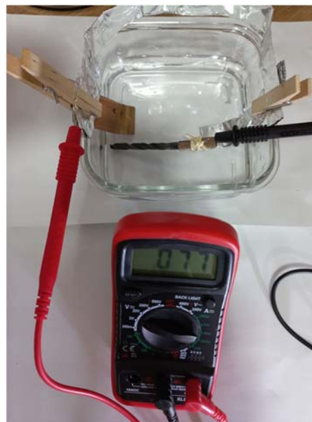
Figura 2. Celda de corrosión en cortocircuito realizada con una lámina de Al. Medida de potencial de Cu en cortocircuito, E_{c, cc} .
