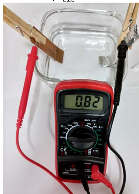
Figura 3. Medida de i_{corr} en cortocircuito realizado a través del multímetro.
