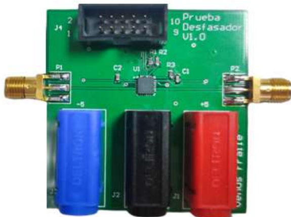
Figura 17. PCB Prueba Desfasador
