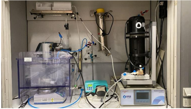
Figura 2. Sistema de fotocatalisis con nanoburbujas.
