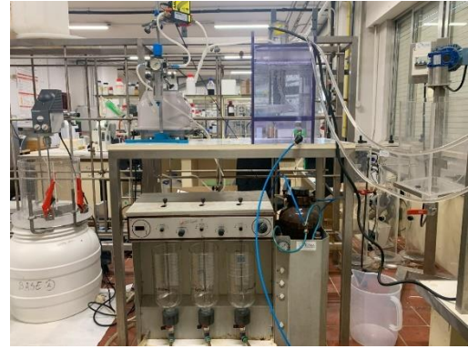
Figura 3. Flotación por aire disuelto (DAF) con nanoburbujas.
