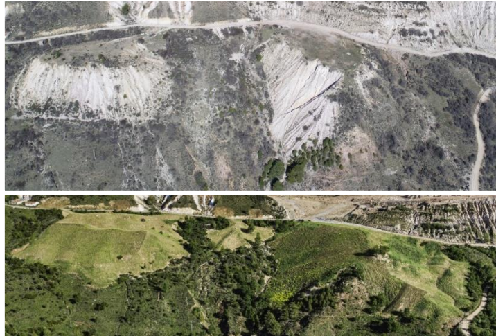
Figura 1. Restauración geomorfológica de las escombreras exteriores de la mina Santa Engracia (Peñalén, Guadalajara), realizada con el método GeoFluv-Natural Regrade. Izquierda, situación pre-restauración, marzo de 2020 (fotografía de Diedro). Derecha, situación post-restauración, mayo de 2021 (fotografía de M.A. Langa).
