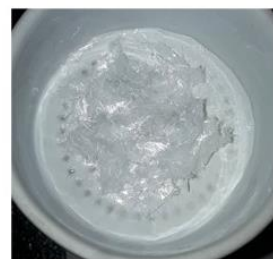
Figura 2. Escamas de PET verde de una botella de plástico coloreada y DMT blanco después de la despolimerización
