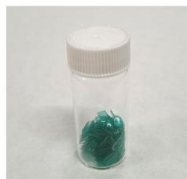
Figura 2. Escamas de PET verde de una botella de plástico coloreada y DMT blanco después de la despolimerización
