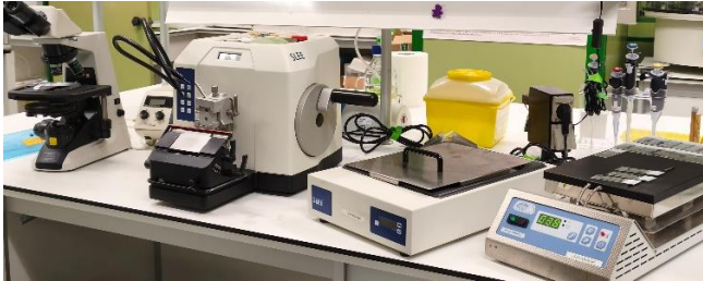
Figura 2. Línea de parafina, incluyendo procesador de tejidos, microtomo, baño de flotación de cortes, placa calefactora y microscopio, utilizada para el procesamiento y análisis de tejidos blandos y muestras descalcificadas.
