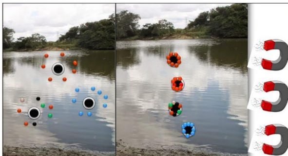
Figura 1. Actuación de los sistemas basados en nanopartículas magnéticas-adsorbentes
