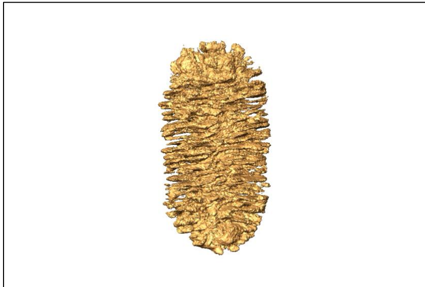
Visualizaciones 3D (obtenidas por tomografía electrónica y microscopía electrónica) de nanopartículas de oro con propiedades cuasi-helicoidales (quirales) obtenidas químicamente, que les confieren una capacidad peculiar para interactuar con la luz polarizada circularmente (Adrián Pedraza Tardajos, Universidad de Amberes).
