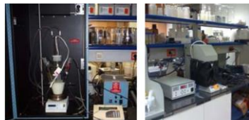
Figura 1. Instalación de electrooxidación
