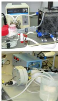
Figura 2. Instalación de electrooxidación
