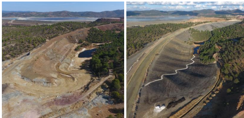
Figura 2. Restauración geomorfológica de un sector de la mina Riotinto (Atalaya Mining, Huelva). Izquierda, situación en el año 2021. Derecha, situación posterior al remodelado geomorfológico, en el año 2024 (fotografías de Atalaya Mining).
