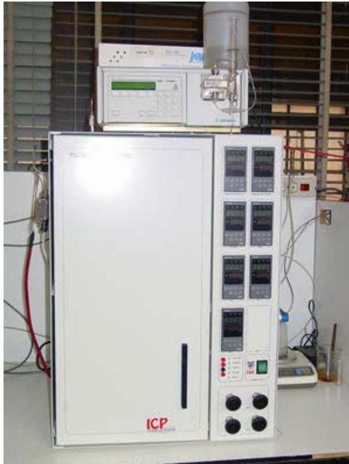
Reactor continuo en condiciones subcríticas con flujo descendente (TBR).
