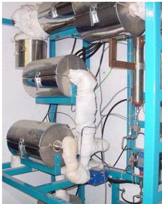
*Reactor continuo que trabaja en condiciones supercríticas.*
