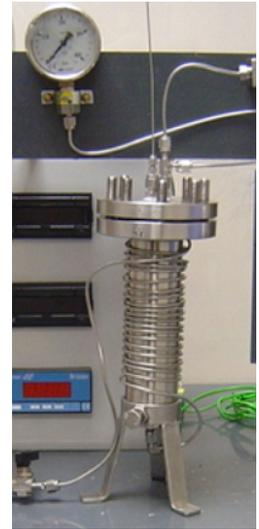
Figura 1. Imagen de un recipiente de esterilización con CO<sub>2</sub> supercrítico para productos sólidos de escala laboratorio.
