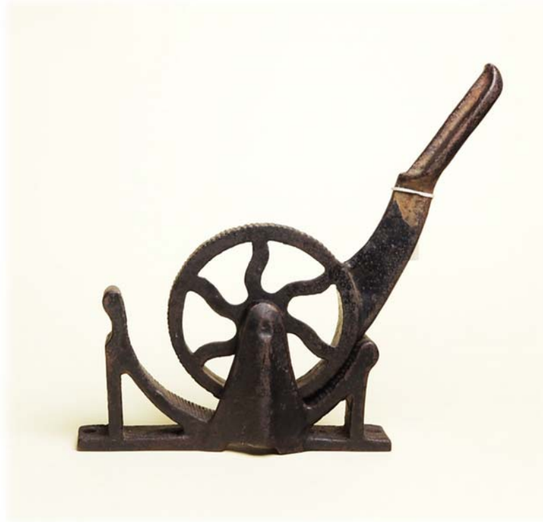
Imagen 1. MFH 3933. Prensa de rotación para tapones de corcho. Finales siglo XIX.
