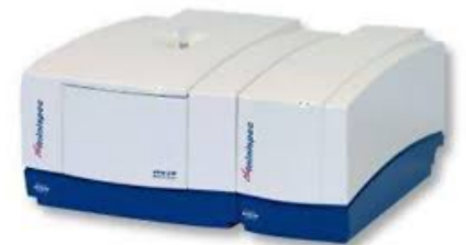
Relaxómetro Bruker Minispec. Asignatura: Resonancia Magnética Nuclear, Ultrasonidos e Imagen Molecular.
