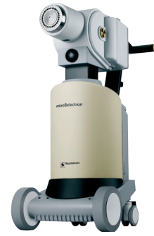
Unidad de Braquiterapia de alta tasa Microselectron (Elekta) Asignatura: Radiofísica
