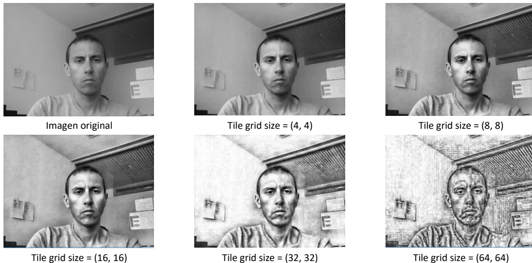
Figura 30: Efectos de CLAHE con diferentes tamaños de tile grid
