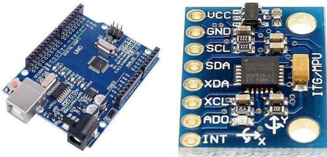
Ilustración 3. Placas del microcontrolador y sensor inercial
