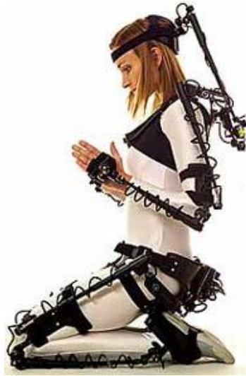
Ilustración 2. Sistema mecánico de captura de movimiento
