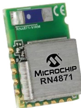
Imagen 99. Módulo BLE (Bluetooth Low Energy) con antena integrada.
