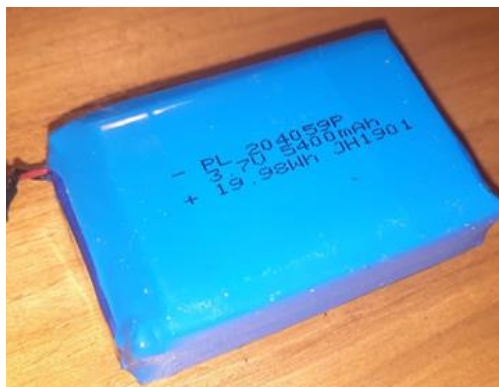
Imagen 91. Batería 204059P de 3.7V y 5400 mAh de capacidad.
