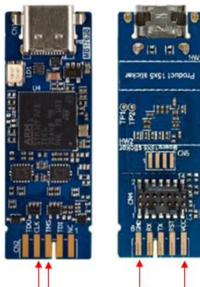
Imagen 10. Caras del programador utilizado y pines usados. Imagen del autor.
