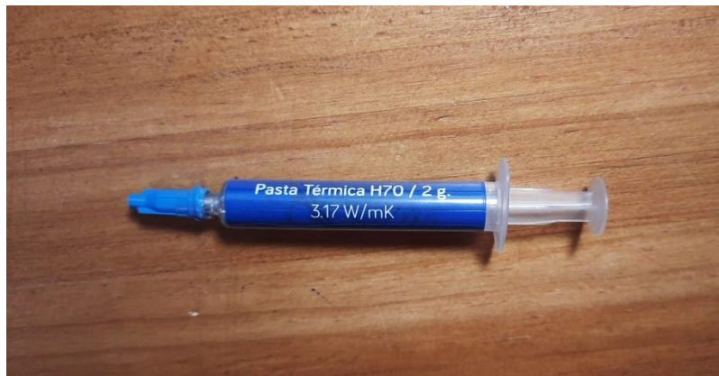
Imagen 32. Pasta térmica usada en la unión del MOSFET con el disipador.
