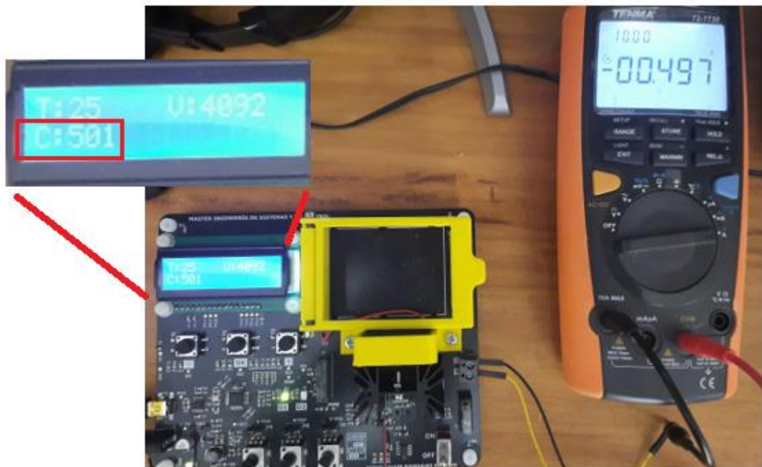
Imagen 71. Comparativa de lecturas de corriente con el polímetro y la carga electrónica.
