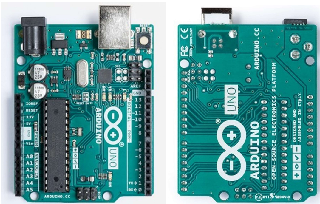
Ilustración 9. Arduino UNO rev3 frontal y reverso. Fuente store.arduino.cc.
