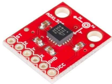
Ilustración 14. Placa de prototipado de Sparkfun para el acelerómetro ADXL335. Fuente Sparkfun.com.
