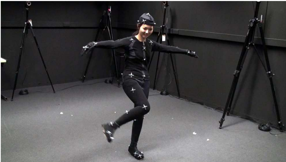
Ilustración 2. Captura de movimiento óptica con marcadores pasivos. Fuente sp.edu.spg.
