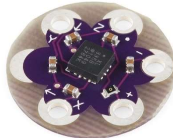
Ilustración 15. Placa de prototipado de Lilypad para el acelerómetro ADXL335. Fuente Sparkfun.com.
