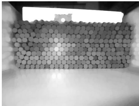
Figura 11. Imagen obtenida por la aplicación de una operación morfológica de apertura
