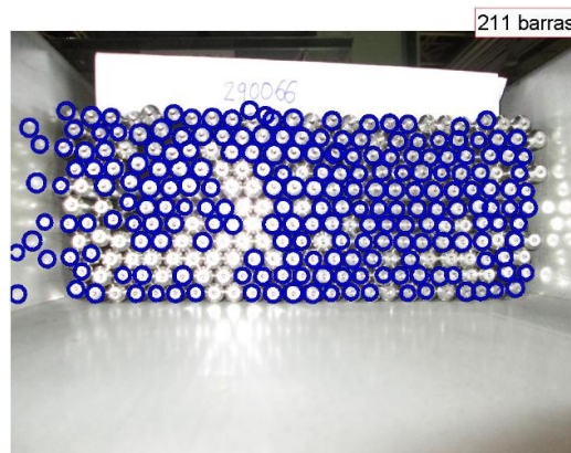
Figura 22. Resultado de la detección de barras mediante el procedimiento D
