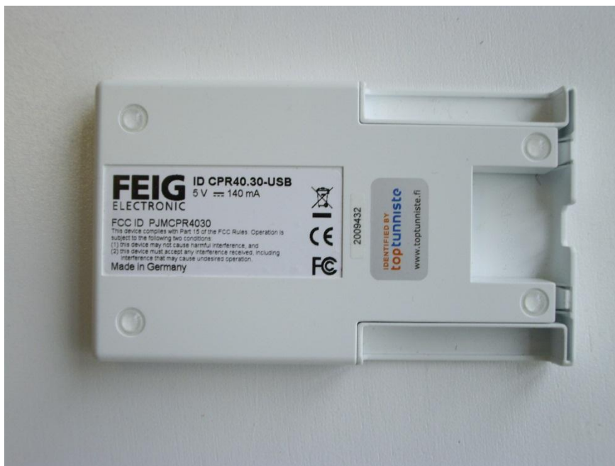
Figura 7: Dispositivo para lectura/escritura NFC
