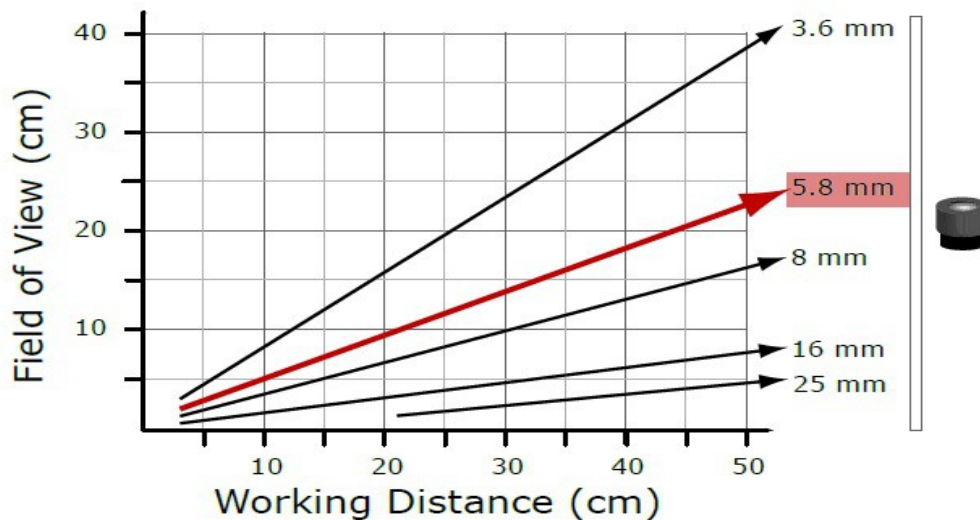
FIGURA 5.16.- FOV vs distancia de trabajo para las lentes Cognex
