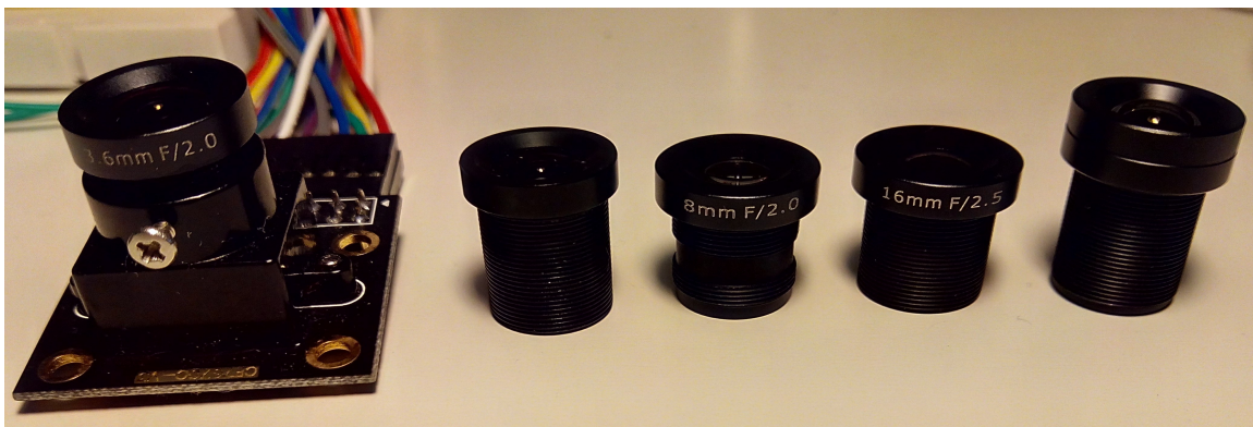
FIGURA 5.15.- Juego de lentes Cognex para sensores de 1/6”
