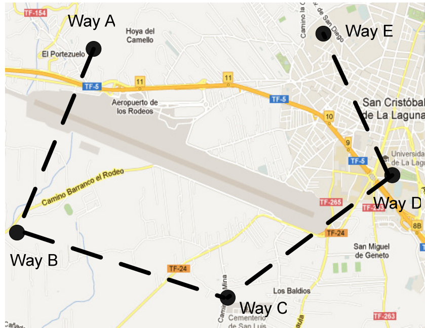
Figura 2.3: Ejemplo plan de vuelo lateral
