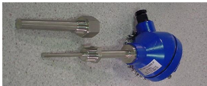
Figura 61. Sensor de temperatura TAD081 de IFM instalado en el depósito.
