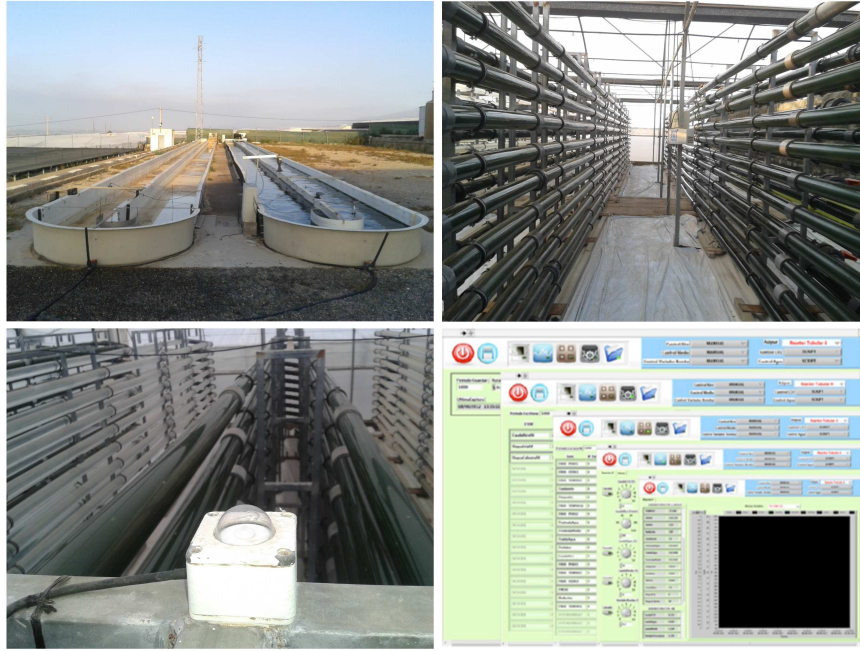
Figura 1.1: Imágenes de un fotobiorreactor abierto tipo raceway (arriba izquierda), otro cerrado tipo tubular (arriba derecha), sensor de radiación (abajo izquierda) y captura del sistema SCADA (abajo derecha)
