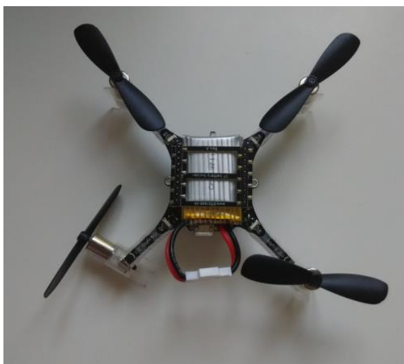
Figura 50 : Aspecto del Crazyflie 2.0 tras un impacto contra el entorno
