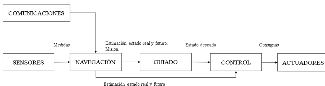
Figura 5 Flujo de datos GNC incluyendo comunicaciones
