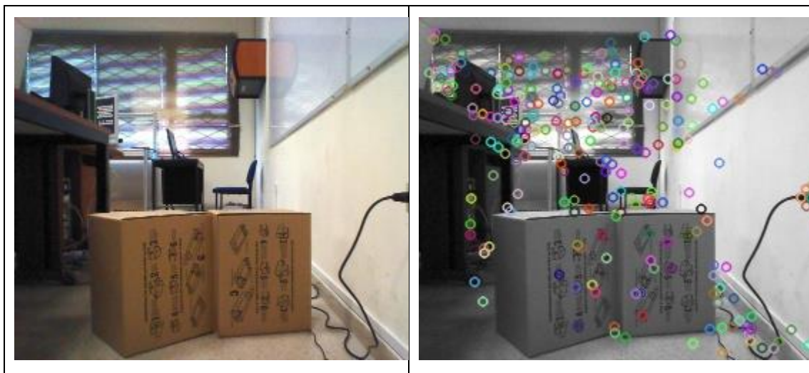
Figura 43. Aplicación de SIFT en la imagen original.
