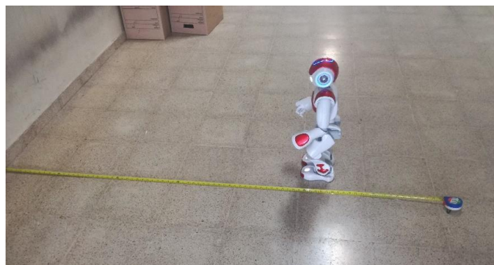
Figura 80. Escenario para medición de la distancia generada por el sonar.
