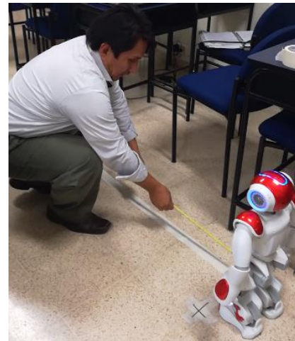
Medición de la coordenada para verificación de posición
