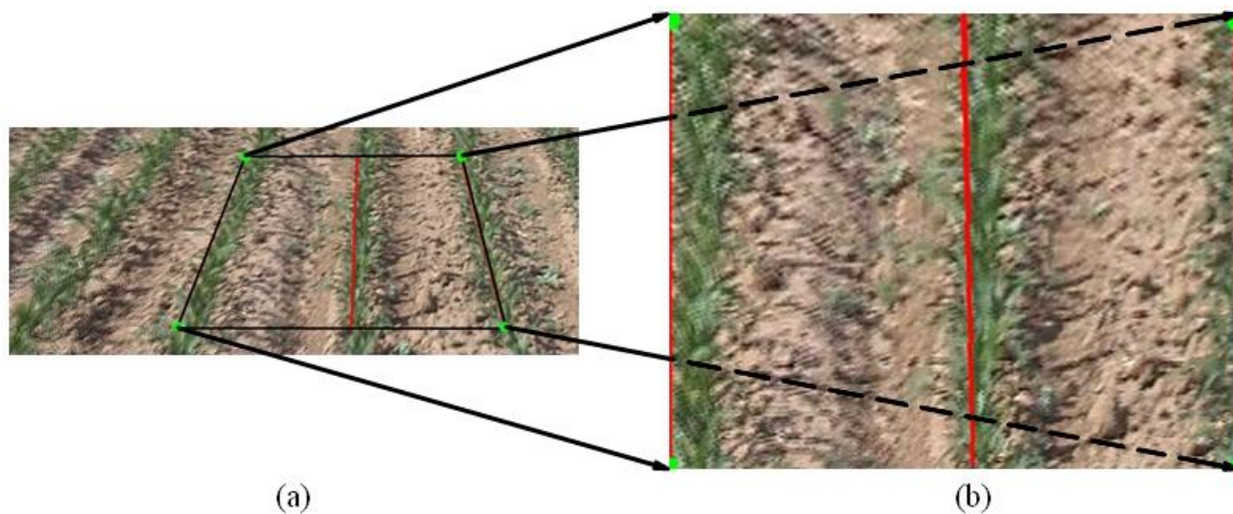
Figura 14. (a) Fotograma en perspectiva con el trapecio seleccionado por el algoritmo como región de interés. (b) Vista cenital de la región de interés seleccionada y mostrada en (a). La perspectiva ha sido eliminada y se recupera el paralelismo de los cultivos.
