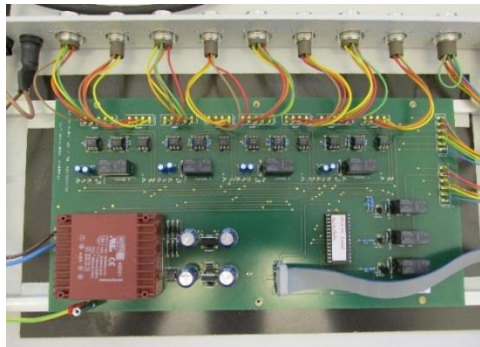
Figura 31. Rack de enclavamientos usado en el LHC/L4/AWAKE.
