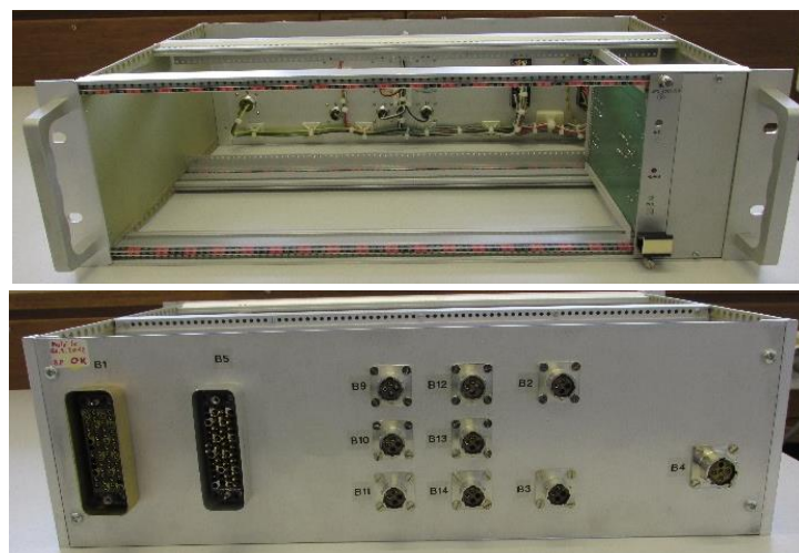
Figura 36. Rack de enclavamientos usado en el SPS.
