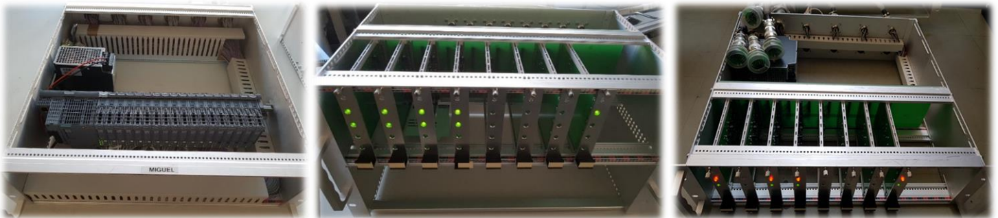
Figura 67. Segunda versión desarrollada del prototipo de control de VVGS completo.
