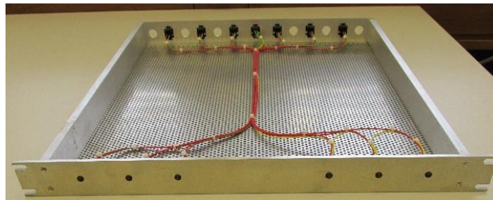
Figura 35. Rack RXVF-VPI para las conexiones de enclavamientos de las VPI en el SPS.
