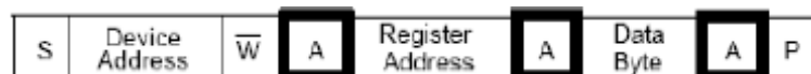
Figura C.2a. Operación de escritura en el bus Fuente: Kodak KAC-9618 CMOS Image – http://www.kodak.com
