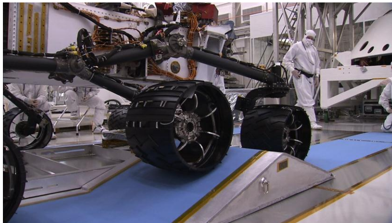
Figura 11: Sistema “Rocker-Bogie” en Rover “Curiosity”, NASA.
