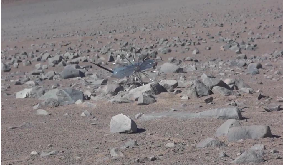
Figura 85: Prueba en terreno con obstáculos frecuentes tipo regolito lunar.
