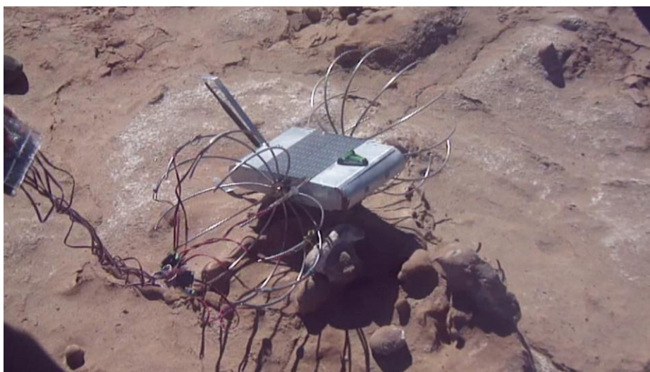
Figura 93: Prueba en terreno con sensores de presión y flexión en terreno rocoso.
