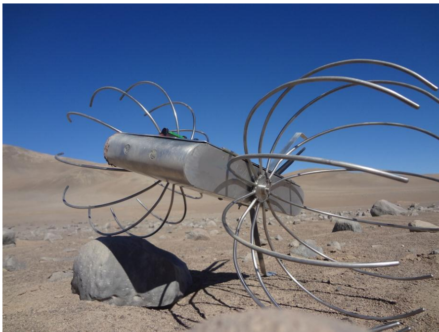
Figura 84: Prueba en terreno con obstáculos tipo regolito lunar.
