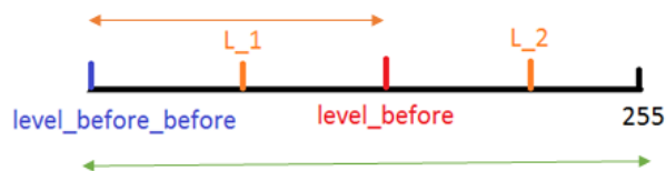
FIGURA 3.4: Franja de valores de niveles de grises que conforman el numerador y el denominador del factor de decisión para el umbral L_{-1} .
