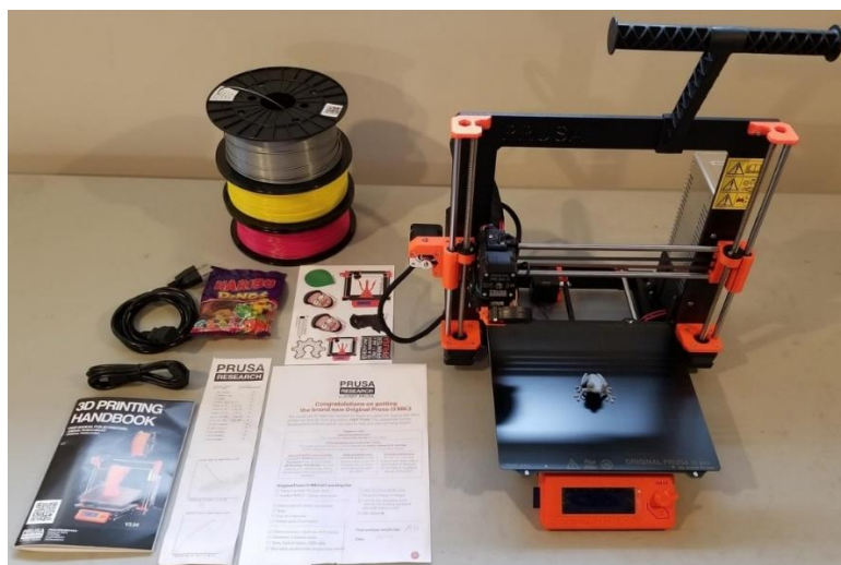
Figura 1.1.1 Impresora 3D de Prusa i3 con un espacio de trabajo de 200x200x200mm[11]
