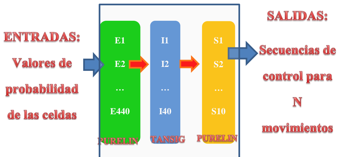
Figura 18: Esquema de la red neuronal diseñada
