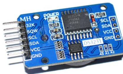
Figura 5: Reloj de tiempo real modelo DS3231.
