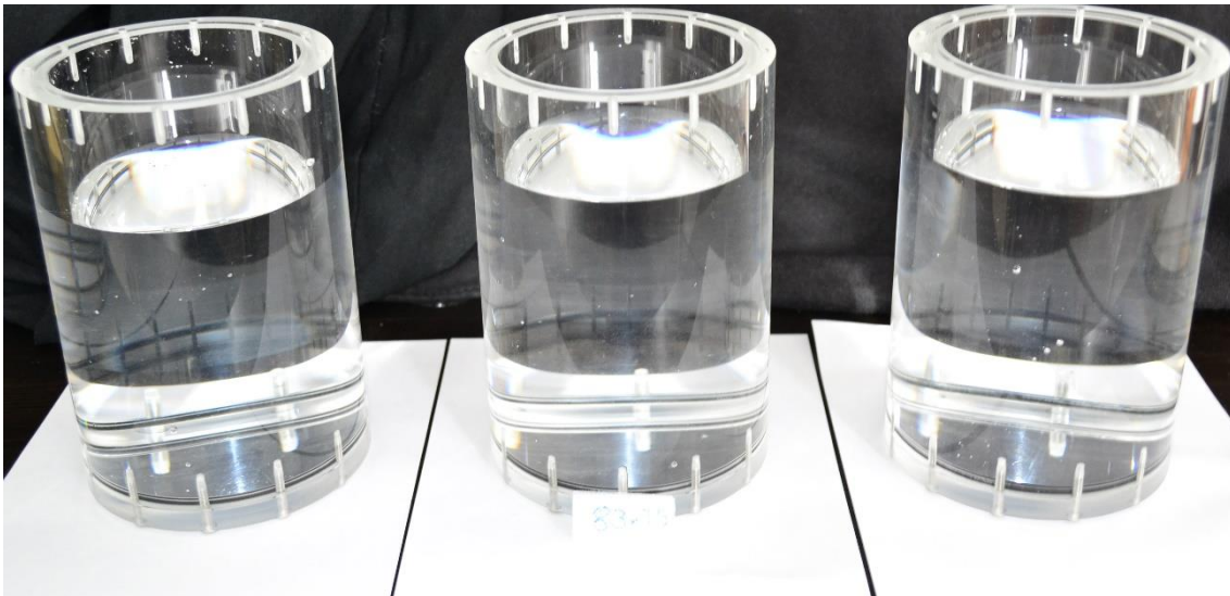
Figura 43: Prueba de estanqueidad con junta de sellado de 83x3.5mm.
