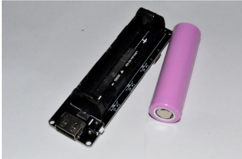
Figura 4: Módulo de alimentación fabricado por Sincere Company con batería 18650 de Samsung a su derecha.
