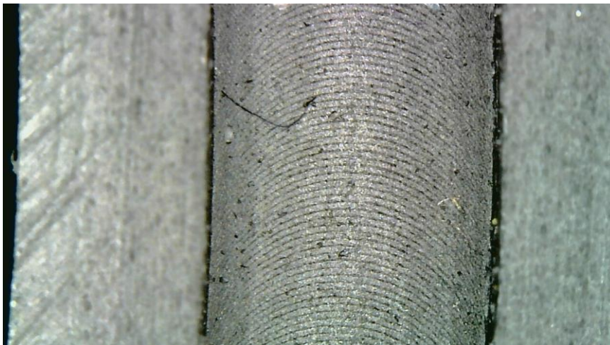
Figura 17: Detalle en microscopio del canal fabricado para la colocación de la junta de sellado.
