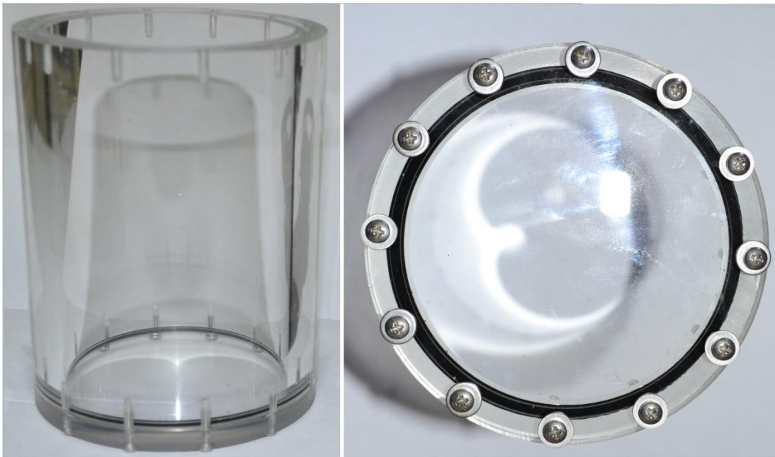
Figura 16: Figura 13: Detalle del cuerpo de la carcasa de metacrilato fabricada con una tapa colocada (izquierda) y una tapa lateral de la misma atornillada incluyendo arandelas y junta de sellado (derecha).
