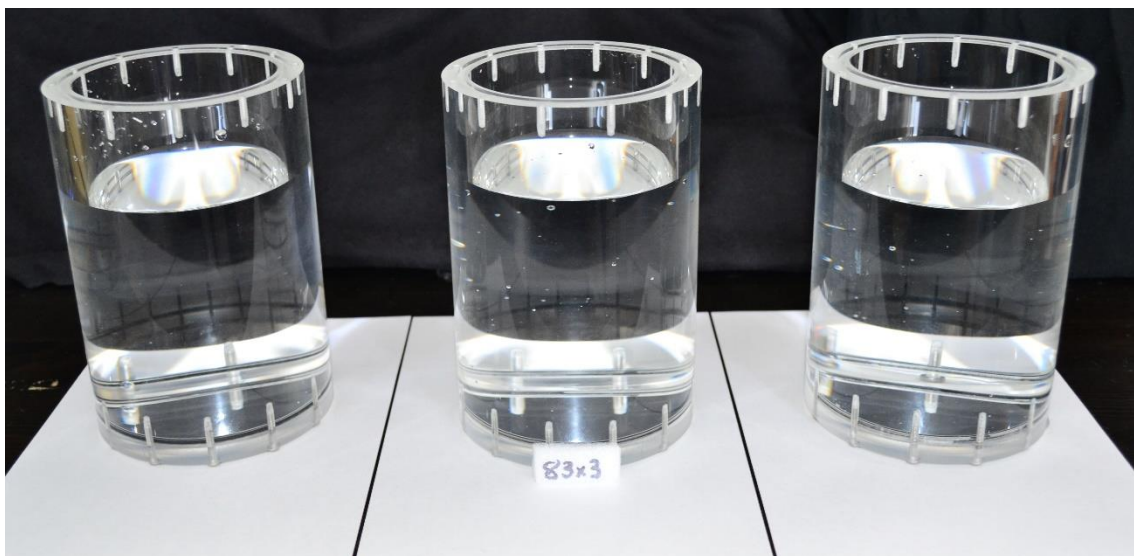
Figura 41: Prueba de estanqueidad con junta de sellado de 83x3mm.
