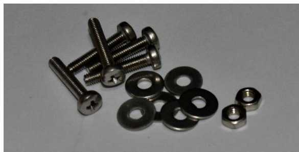
Figura 19: Tornillos de 16x3mm, arandelas de 3mm y tuercas de 3mm. Todo fabricado en AISI-316.
