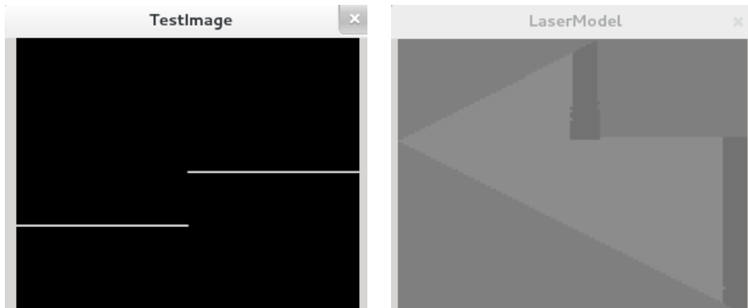
Figura 44: Ejemplo de modelo creado a partir de la medición láser de dos objetos enfrentados a diferente distancia.
