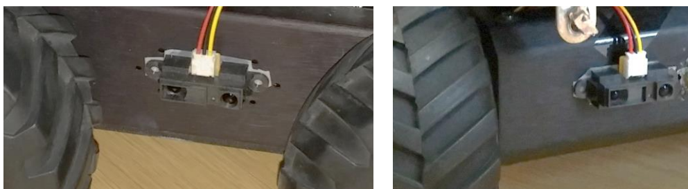
Figura 79: Detalle de sensores infrarrojos lateral y frontal.
