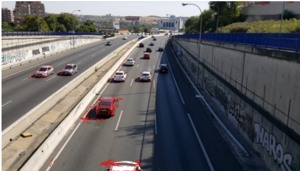
Figura 6. Flujo óptico en imagen real
