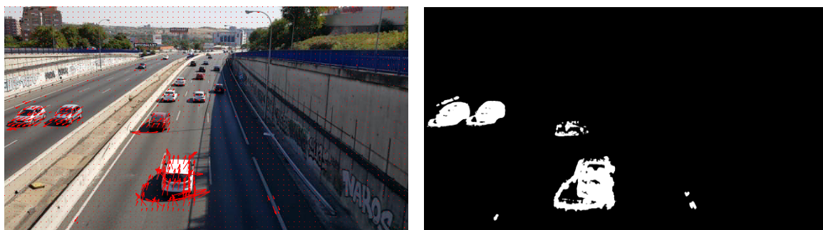
Figura 24. (a) Detección del flujo óptico mediante Lucas-Kanade; (b) Imagen binarizada a partir de la magnitud del flujo óptico
