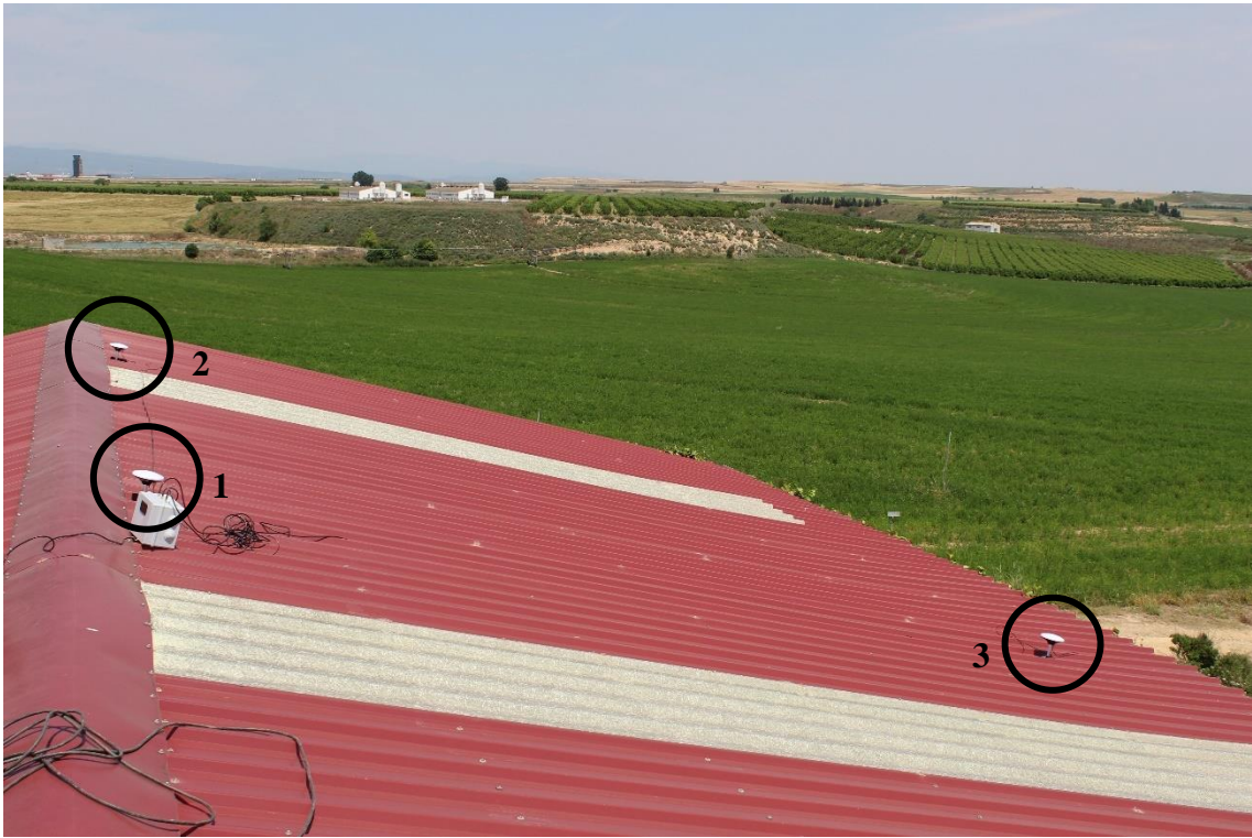
Figura 37 Configuración A de las antenas para las pruebas estáticas
