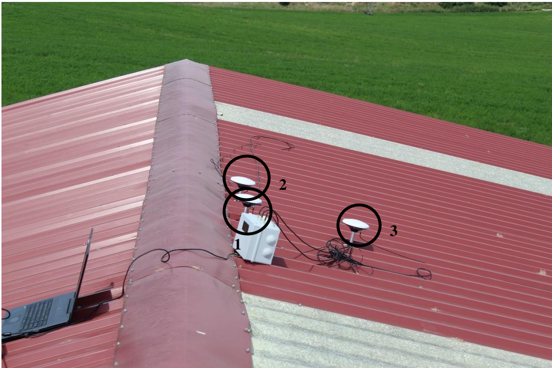
Figura 38 Configuración N de las antenas para las pruebas estáticas
