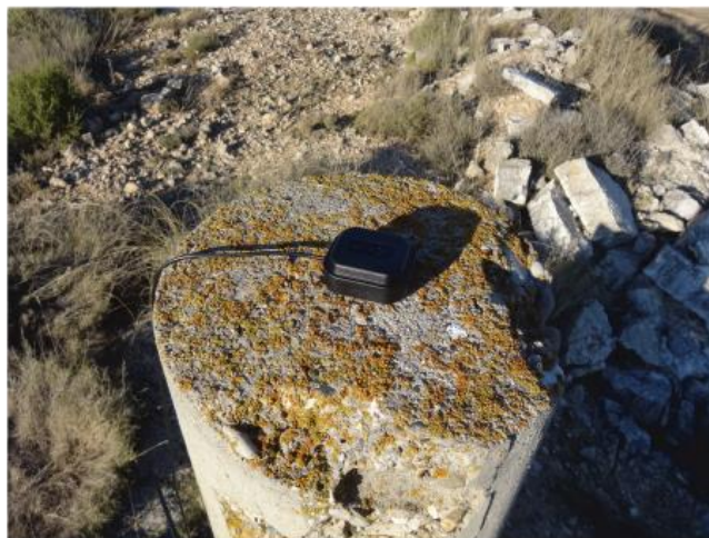
Figura 16 Ficha técnica de punto geodésico calibrado por el ICGC y antena GNSS instalada encima del punto geodésico
