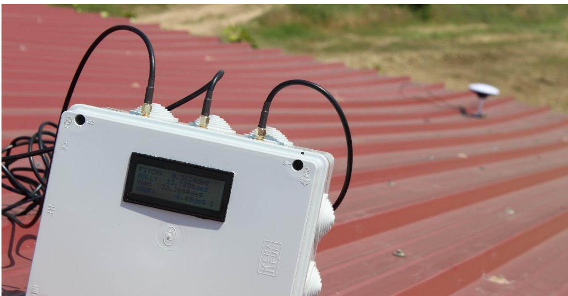
Figura 27 Pantalla del prototipo mostrando la actitud y el yaw rate del sólido
