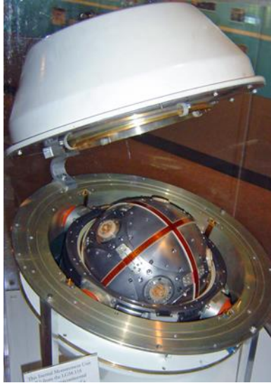
Figura 3 Sistema de guiado inercial del ICBM LGM-118A Peacekeeper. Fuente: Wikipedia
