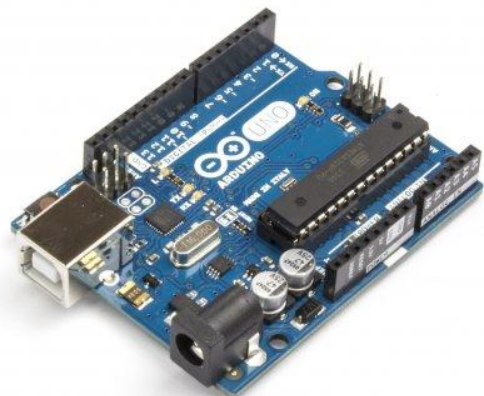
Imagen 5.3: Placa de evaluación Arduino™ Uno
