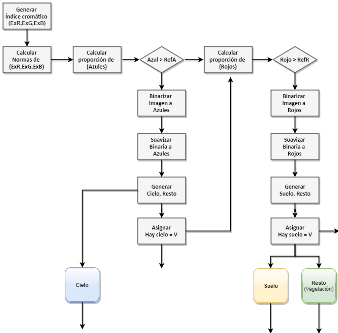
Figura 9. Esquema detallado de la Segmentación por la información de cromaticidad
