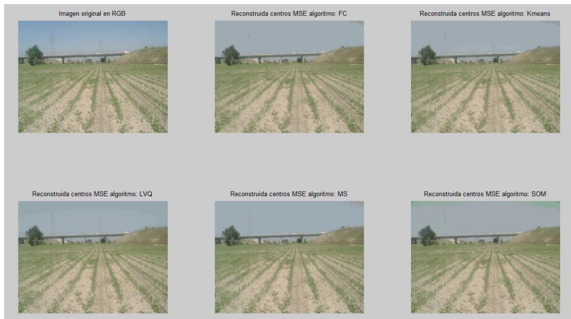
Figura 42. Imagen codificada de acuerdo con los vectores de características detectados por cada uno de los algoritmos probados, con la elección de centros por el menor MSE de agrupación.
