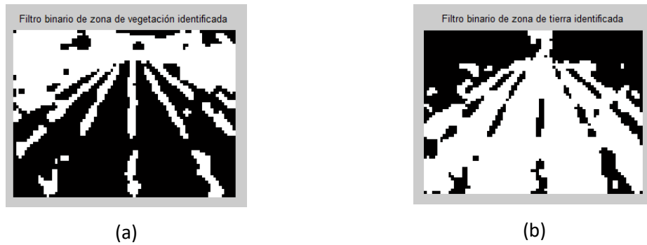
Figura 18. Imágenes conteniendo filtros binarios generados por el método de Otsu de las imágenes de los índices Exceso de Verde (ExG) en (a) y Exceso de Rojo (ExR) en (b) de la muestra 2
