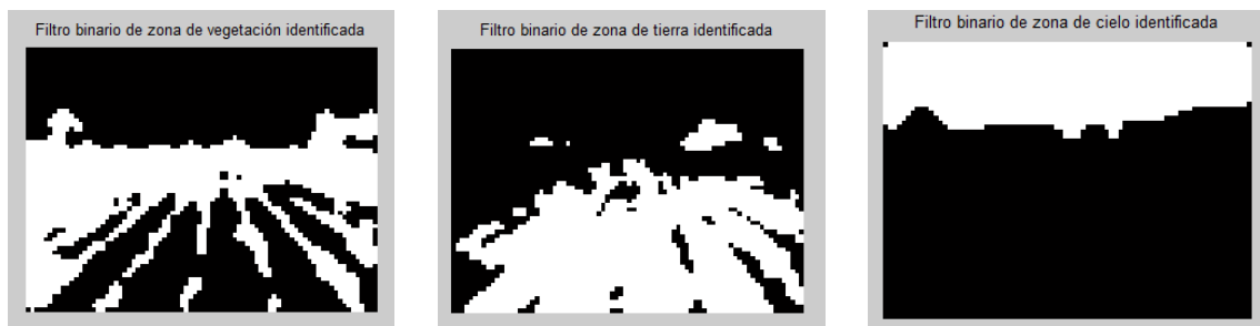
Figura 30. Imágenes conteniendo filtros binarios generados por el método de Otsu de las imágenes de los índices Exceso de Verde (ExG) en (a), Exceso de Rojo (ExR) en (b) y Exceso de Azul (ExB) en (c) de la muestra 4
