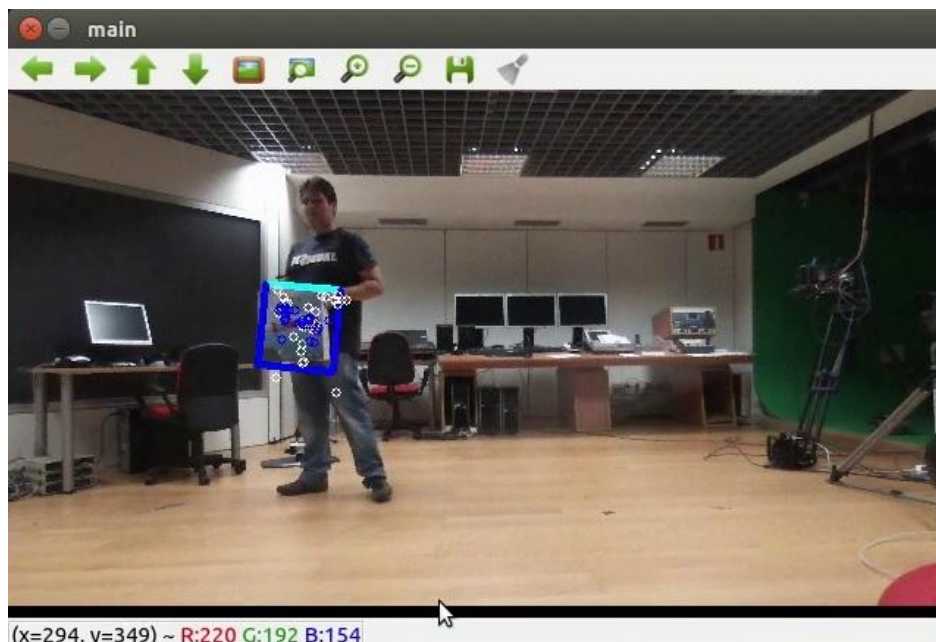
Figura 36. Tracking de un objeto indoor con detector FAST
