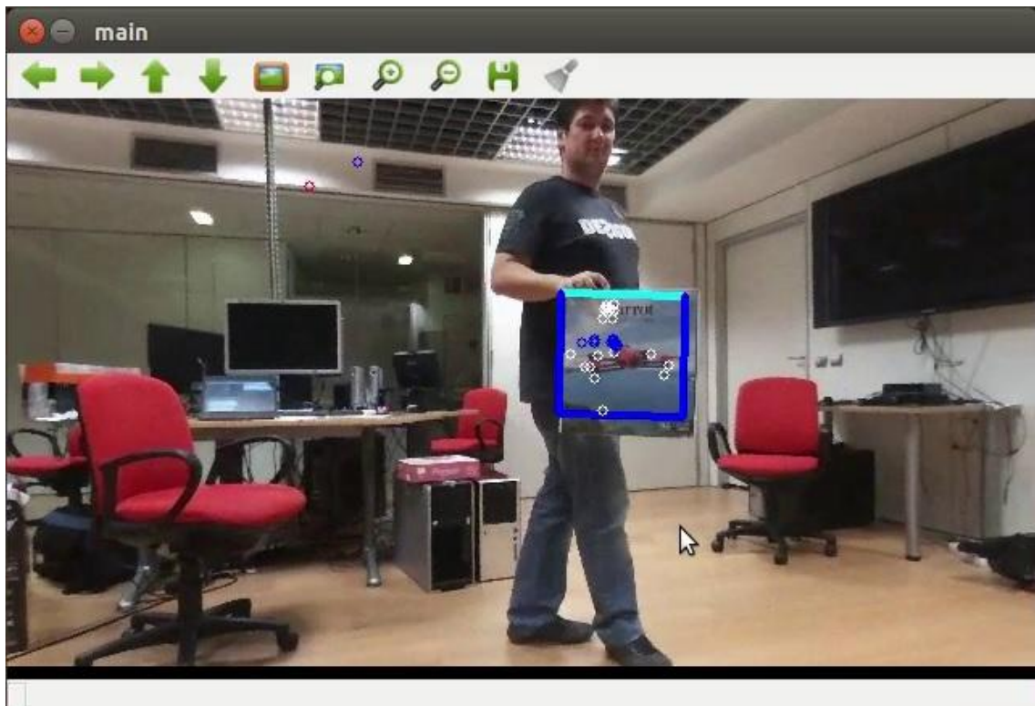
Figura 50. Tracking de un objeto permitiendo el movimiento Yaw
