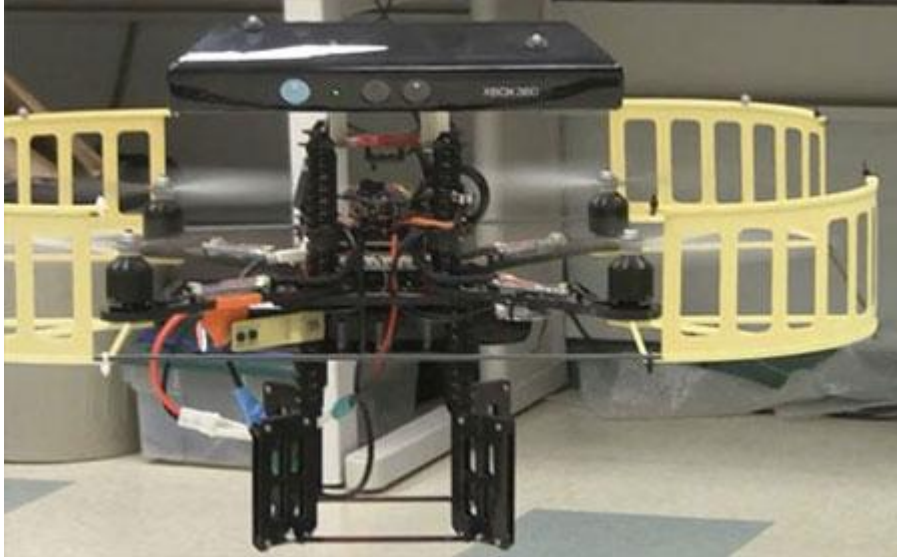
Figura 8 Robot autónomo que usa el sensor kinect para la navegación
