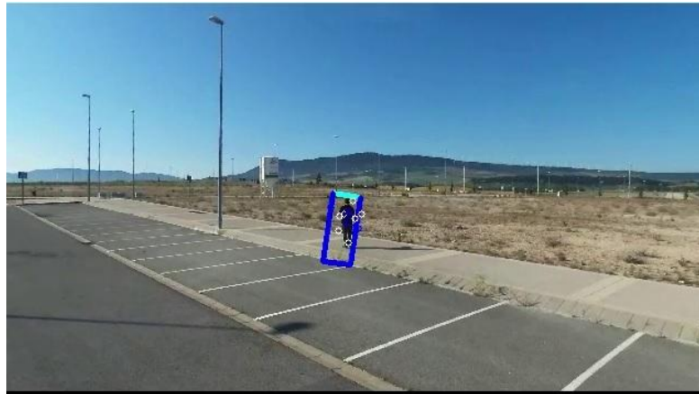
Figura 77. Mala detección de la anchura del sujeto
