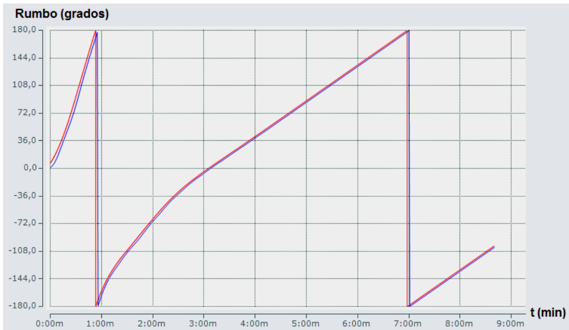
Figura 49: Maniobra Paramétrica - Rumbo Prueba Círculo: Señal de Referencia (rojo); Barco (azul)
