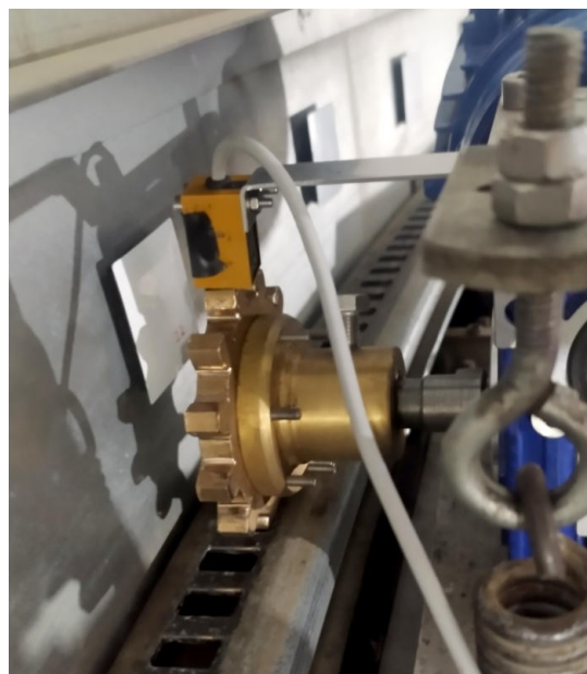
Figura 3.9: Sensor magnético instalado sobre el piñón de uno de los motores que mueven la cúpula de forma que al rotar el piñón, el sensor detecta el paso de sus dientes. (Fuente: elaboración propia)
