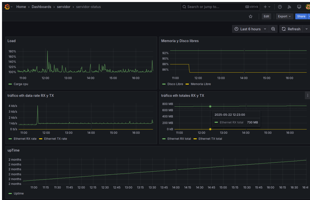
Figura 3.25: Dashboard de Grafana para visualizar los datos de monitorización del estado del servidor. (Fuente: elaboración propia)
