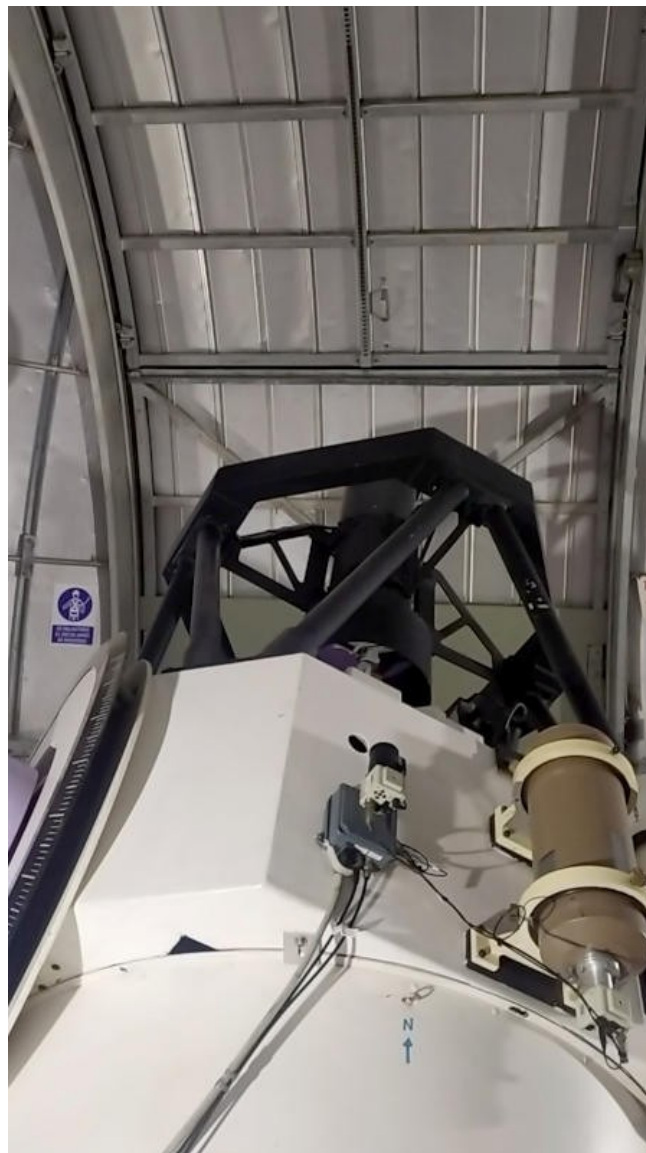
Figura 4.3: Pruebas de alineamiento de la cúpula con el telescopio. (Fuente: elaboración propia)
