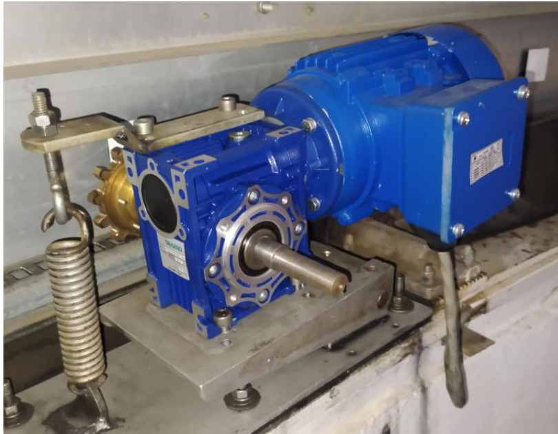
Figura 2.1: Uno de los dos motores trifásicos que mueven la cúpula. Se puede ver la caja reductora con el eje de salida y el piñón que engrana en la cremallera de la cúpula. (Fuente: elaboración propia)
