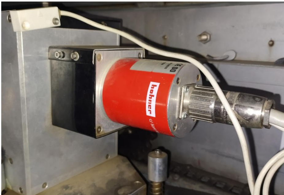
Figura 2.3: Encoder absoluto del fabricante Hohner 7 . En la parte superior izquierda se aprecia el imán que proporcionaba la posición de referencia cuando se utilizaba el encoder relativo. (Fuente: elaboración propia)
