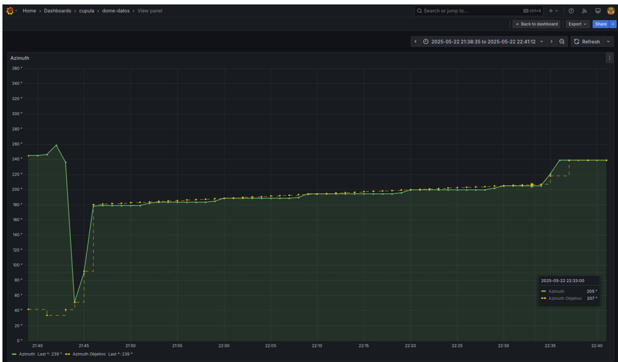
Figura 4.4: Pruebas de control de la cúpula en el transcurso de una observación astronómica. (Fuente: elaboración propia)
