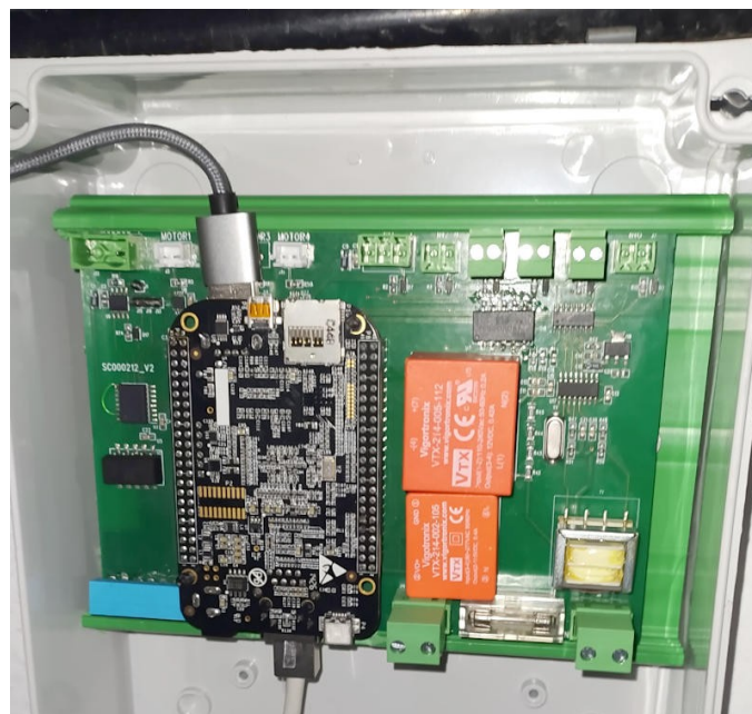
Figura 3.1: Placa de control. A la izquierda se puede ver la SBC Beaglebone Black conectada a la placa con el cable USB del lector RFID en la parte superior y el cable Ethernet en la parte inferior. (Fuente: elaboración propia)
