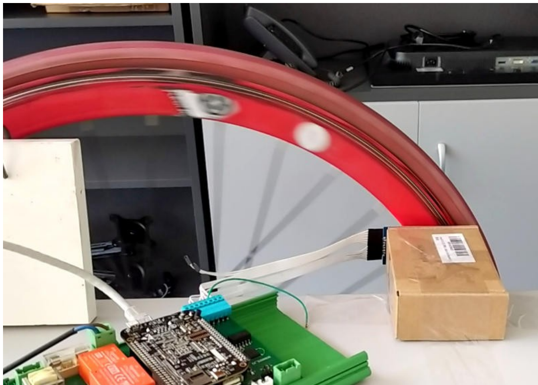
Figura 4.1: Pruebas de lectura de tags RFID en movimiento con rueda de bicicleta. (Fuente: elaboración propia)
