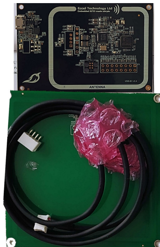
Figura 3.6: Lector RFID ECCEL Chilli USB-B1 30 con antena externa de 80 x 80 mm. (Fuente: elaboración propia)
