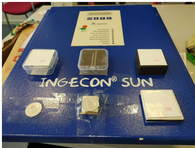
Figura 3.7: Diferentes tags RFID con varias distancias de separación a una chapa metálica para realizar pruebas de lectura. (Fuente: elaboración propia)
