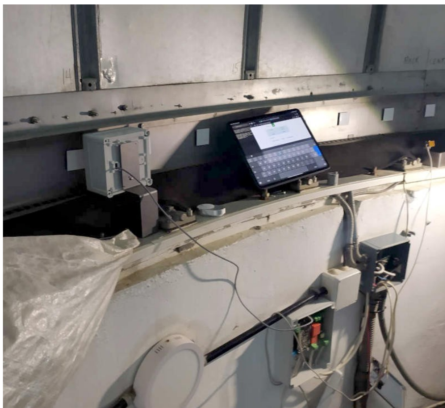
Figura 4.2: Pruebas de lectura de tags RFID en la cúpula. (Fuente: elaboración propia)
