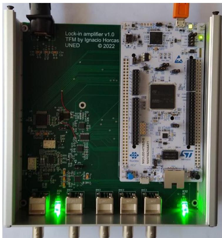
Figura 60. Versión final del dispositivo desarrollado (vista superior sin cubierta ni tapa trasera)
