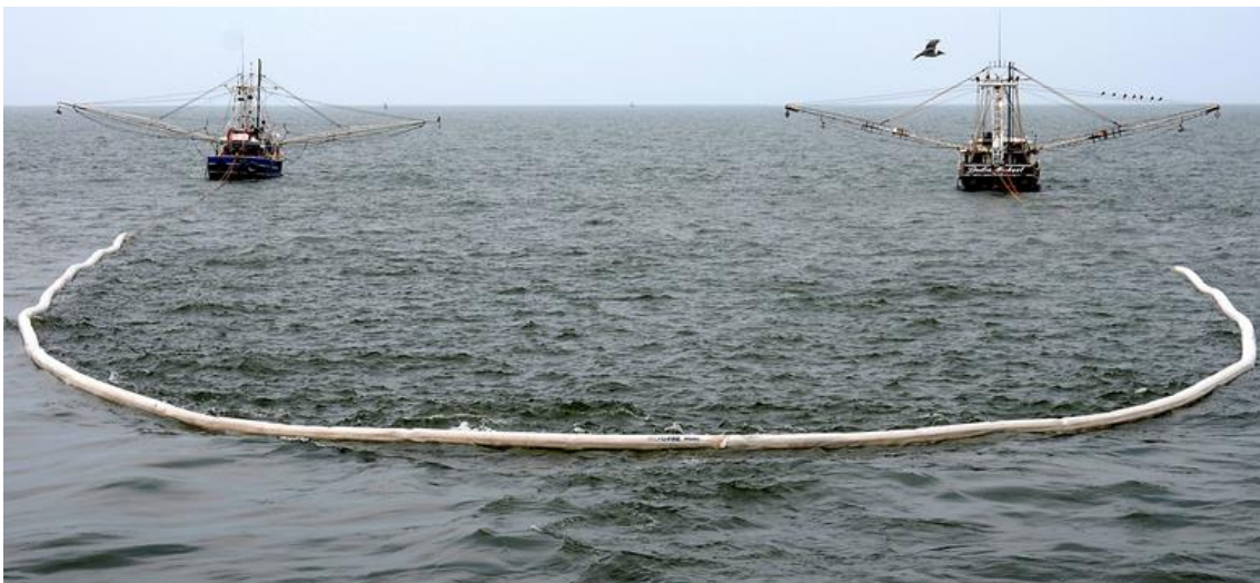
Figura 2.1: Barrera de contención flexible arrastrada por dos barcos 11
