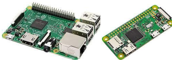
36 Modelos de Raspberry Pi: 3B+ (izquierda) y Zero W (derecha) 17
