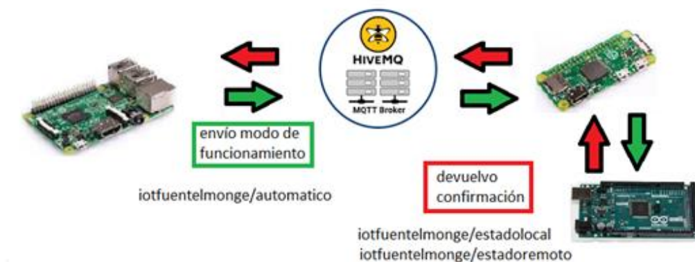
41 Esquema de funcionamiento del envío de instrucciones
