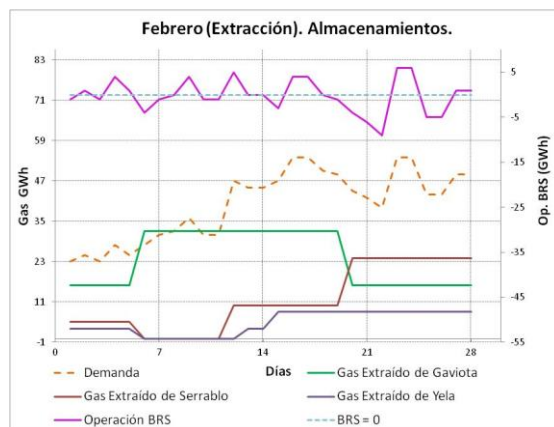
Figura 2.43. Programación de los almacenamientos en el mes de Febrero de 2014. Modulación libre.
